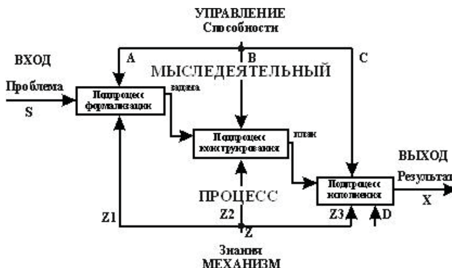
Рисунок 2 – Инвариантная SADT – модель декомпозиции мыслительного процесса разума при решении проблемы на три системообразующих подпроцесса
