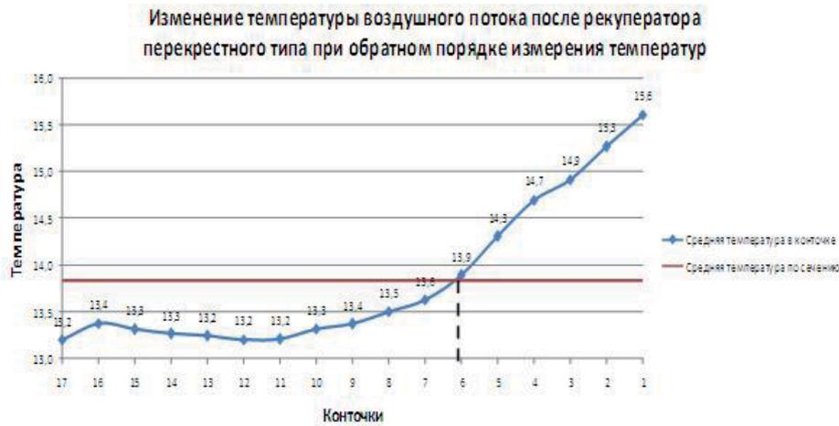
Рисунок 3 – Изменение температуры воздушного потока по сечению прямоугольного воздуховода после рекуператора перекрестного типа при обратном порядке измерения температур.
