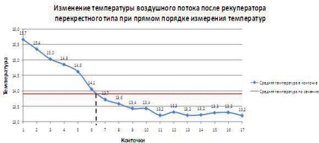
Рисунок 4 – Изменение температуры воздушного потока по сечению прямоугольного воздуховода после рекуператора перекрестного типа при прямом порядке измерения температур.
