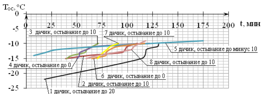
Рисунок 5. Графики изменения температуры в различных зонах подкапотного пространства от времени остывания и температуры окружающей среды
