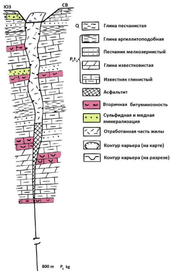
Рисунок 1. План и геологический разрез жилы Садкинского асфальтита
