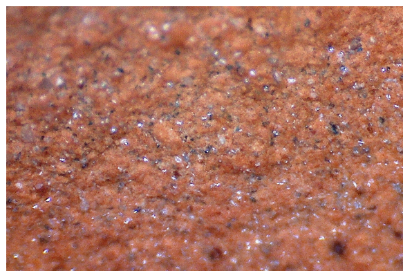
Рисунок 5. Распределение частиц по границам «ячеек» в образцах В-20% SiC, X 200
