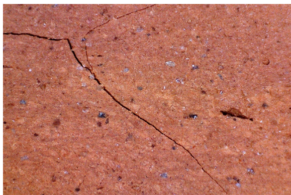
Рисунок 1. Распространение трещины в образце фракции А, X 30
