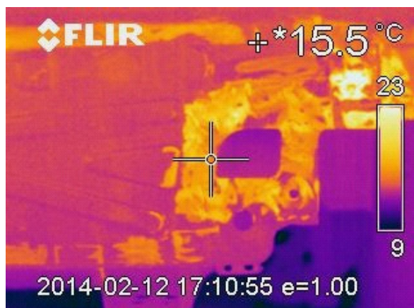
Рисунок 2. Термограмма исследования задней левой части кузова
