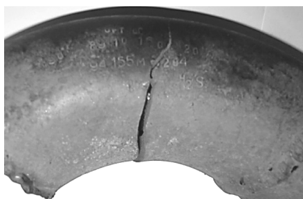
Рисунок 7. Хрупкое разрушение отвода 89x10 мм
