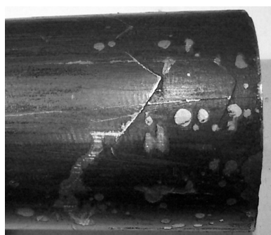
Рисунок 1. Трещины бесшовной трубы из стали типа X18H10T
