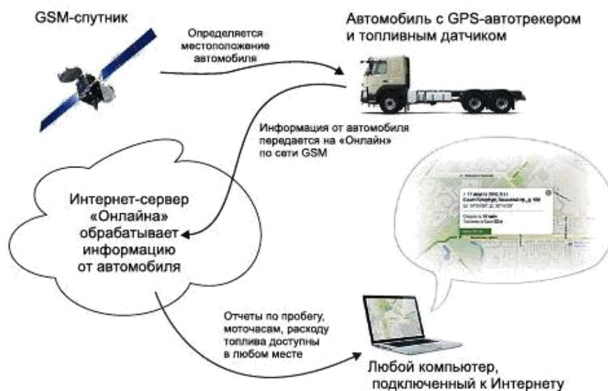
Рисунок 1. Схема работы систем мониторинга транспорта ГЛОНАСС/GPS
