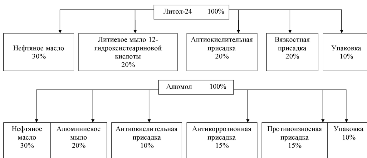
Рисунок 1. Структурно-элементарная модель пластичной смазки «Литол-24» и «Алюмол» со стоимостными характеристиками (в% к себестоимости)
