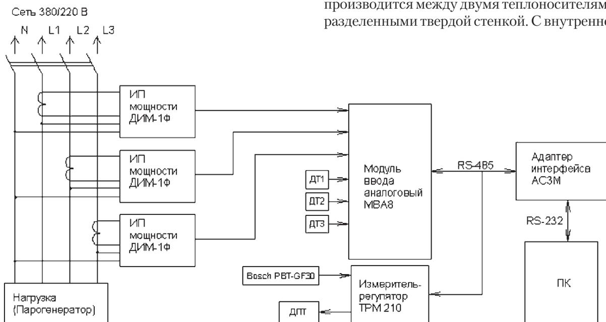
Рисунок 2. Структурная схема измерительно-вычислительного комплекса стенда
