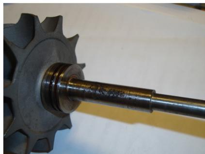
Рисунок 2. Кавитационные разрушения на валу в зоне полости втулки подшипника
