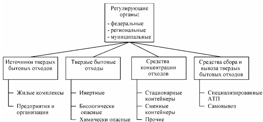
Рисунок 1. Схема системы сбора и вывоза твердых бытовых отходов муниципального образования
