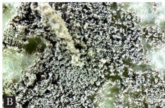
Рисунок 1. Частицы глинистых фракций монтмориллонит содержащей глины: 630–160 мкм (А), 160–40 мкм (В),  $\times 800$
