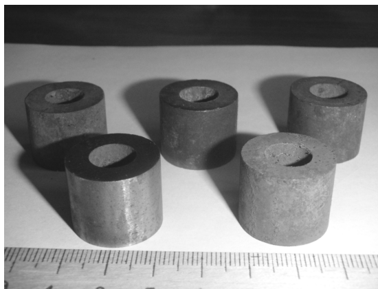
Рисунок 1. Спеченные втулки из материала СП100Д2,5-2
