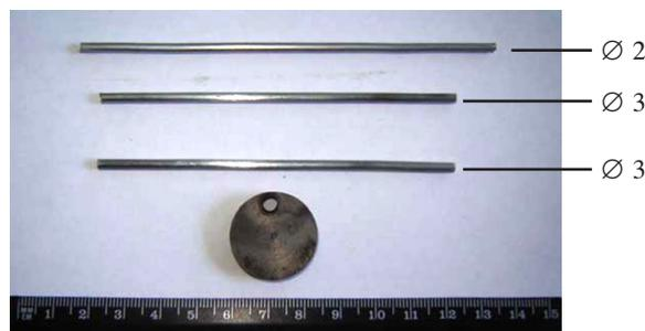
Рисунок 1. Образцы для нанесения покрытий, сверху вниз: УОНИ 13/55, МР-3, ОЗЛ-8, 30ХМА (термообработанная по технологии ГДО)
