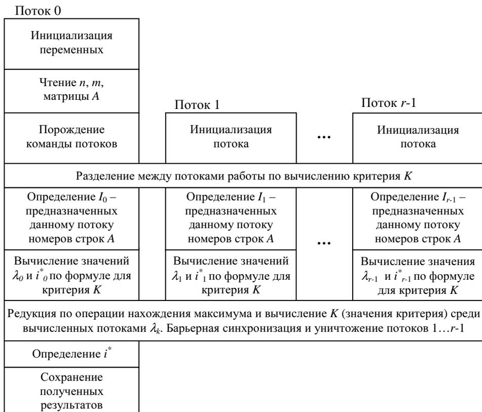
Рисунок 1. Схема параллельного алгоритма поиска оптимальных чистых стратегий статистической игры в условиях полной или стохастической неопределенности для SMP-системы (критерии максимакса, Вальда, пессимизма-оптимизма Гурвица, безразличия и Байеса)
