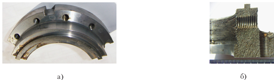
Рисунок 2. Разрушение гайки прижимной
