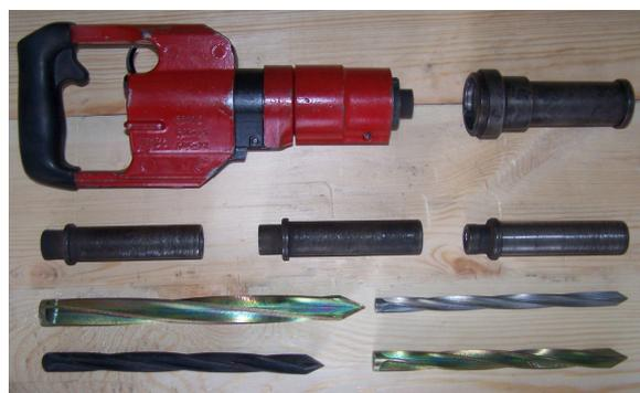
Рисунок 1. Монтажный пистолет ПЦ-84 с модернизированными насадками для огнестрельной забивки разработанных витых крестообразных стержней в массив древесины
