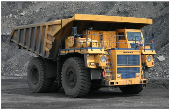
Рисунок 1. Карьерный самосвал БелАЗ-75131 грузоподъемностью 130 тонн
