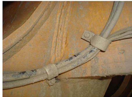
Рисунок 2. Трещины в сварном соединении 2-й поперечины с лонжероном рамы самосвала БелАЗ-75131
