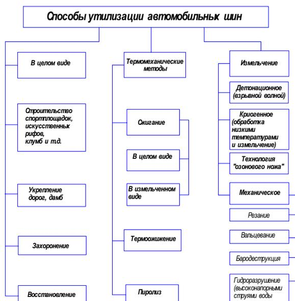
Рисунок 1. Классификация способов утилизации автомобильных шин
