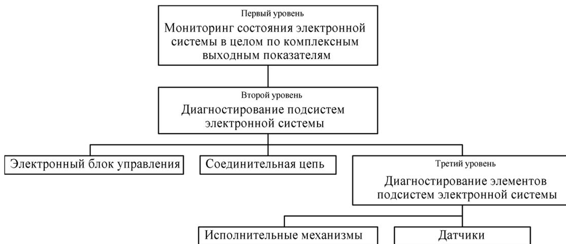
Рисунок 1. Многоуровневая система диагностирования электронных систем
