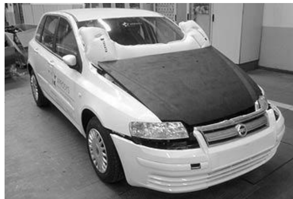
Рисунок 3. Подковообразная наружная подушка для пешеходов
