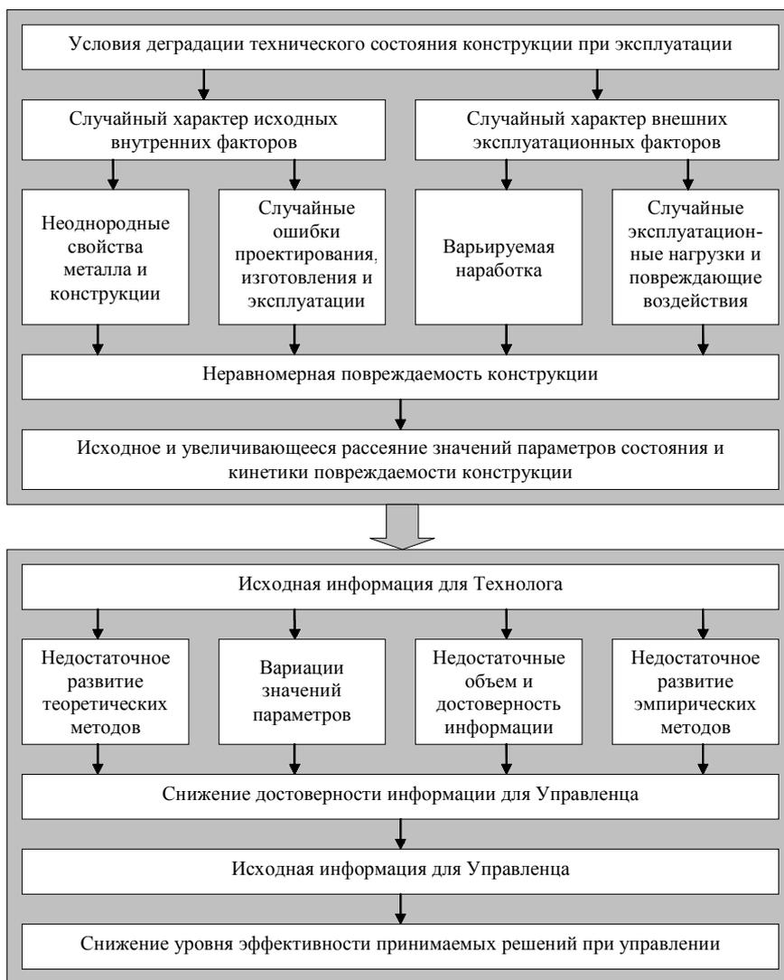
Рисунок 1. Схема факторов, влияющих на полноту описания и эффективность принимаемых решений при управлении техническим состоянием конструкций, подверженных усталостным повреждениям
