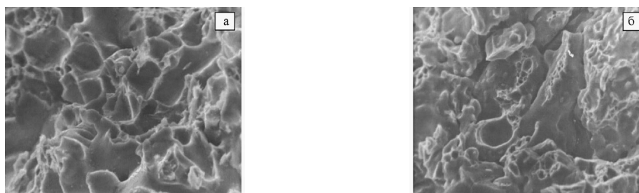
а – до термообработки (твердость 100 НВ; структура феррито-перлитная, поры); б – после термообработки ( T_{\text{н}} – 1000 °С; t – 10 с; V_{\text{охл}} – 600 °С/с; твердость 320 НВ; структура трооститно-сорбитная, поры)
