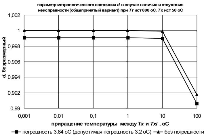
Рисунок 2. Зависимость метрологического параметра  $d$  от приращения температуры холодного спая
