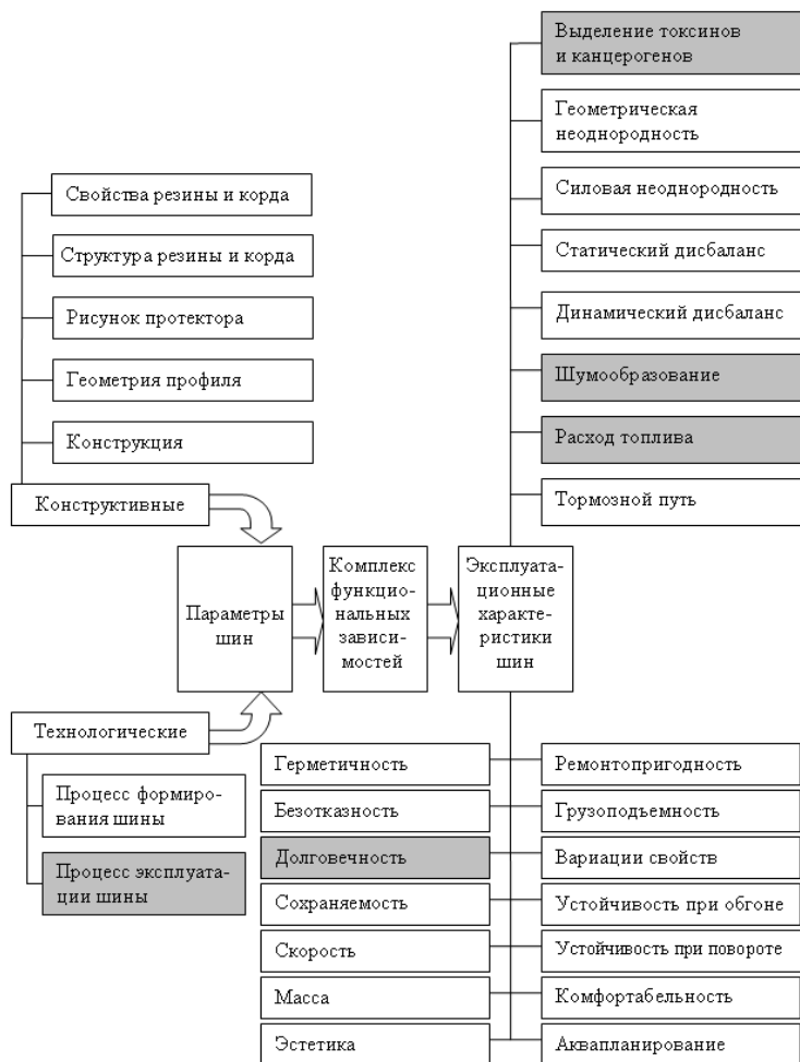
Рисунок 1. Схема зависимостей между параметрами автомобильных шин и их основными эксплуатационными характеристиками
