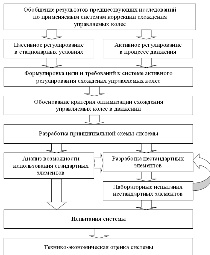
Рисунок 3. Этапы проектирования системы непрерывного регулирования схождения управляемых колес автомобиля в движении
