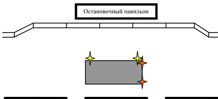
Рисунок 12. Остановка ПС ГПТ на полосе движения
