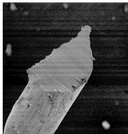
Рисунок 3. Кадр 200х200 мкм, получен с помощью растрового электронного микроскопа. Зонд туннельного микроскопа подведен к исследуемой поверхности.
