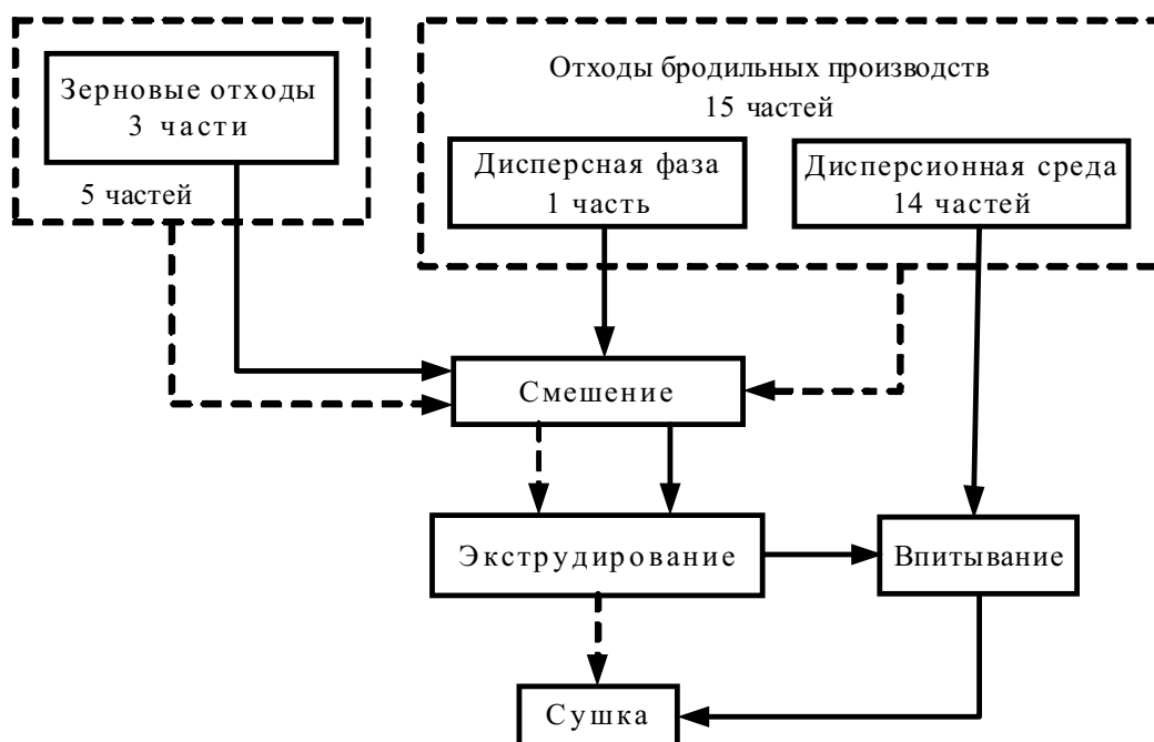
Рисунок 3. Схема центра системы получения кормового продукта утилизацией отходов бродильного производства и зерновых отходов
