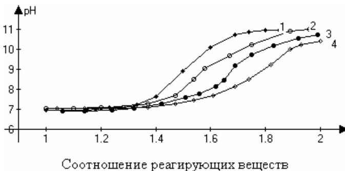
Рисунок 1. Зависимость pH среды в ходе химического взаимодействия в системе  $\text{MgSO}_4 - \text{Na}_2\text{CO}_3 - \text{H}_2\text{O}$  от продолжительности процесса осаждения (мин): 1 – 180; 2 – 120; 3 – 60; 4 – 30.
