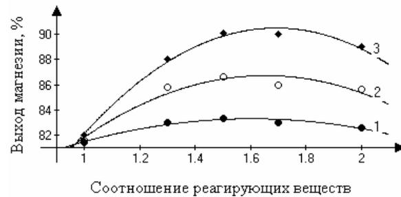
Рисунок 3. Зависимость выхода магнезии от соотношения реагирующих веществ при температуре процесса осаждения (°C): 1 – 40; 2 – 60; 3 – 80
