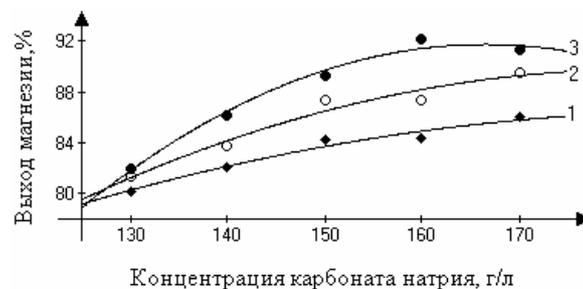
Рисунок 4. Зависимость выхода магнезии от концентрации карбоната натрия при температуре процесса (°C): 1 – 40; 2 – 60; 3 – 80
