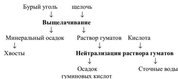
Рисунок 4. Принципиальная схема химической переработки бурых углей
