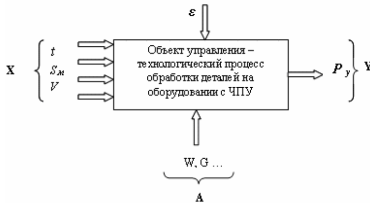
Рисунок 2. Параметры технологического процесса обработки деталей на оборудовании с ЧПУ.
