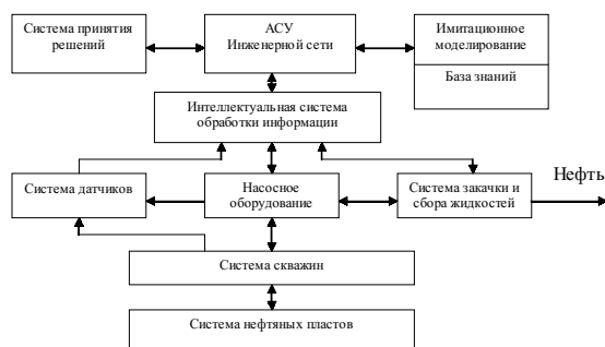
Рисунок 1. Схема системы автоматизированного управления нефтедобычей.
