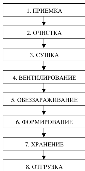
Рисунок 1. Схема технологического процесса обработки зерна на зернозаготовительном предприятии
