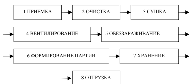
Рисунок 1. Схема технологического процесса обработки зерна на зернозаготовительном предприятии
