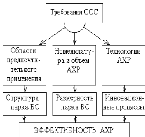
Рисунок 4 - Схема влияния требований ООС на эффективность авиационно-химических работ
