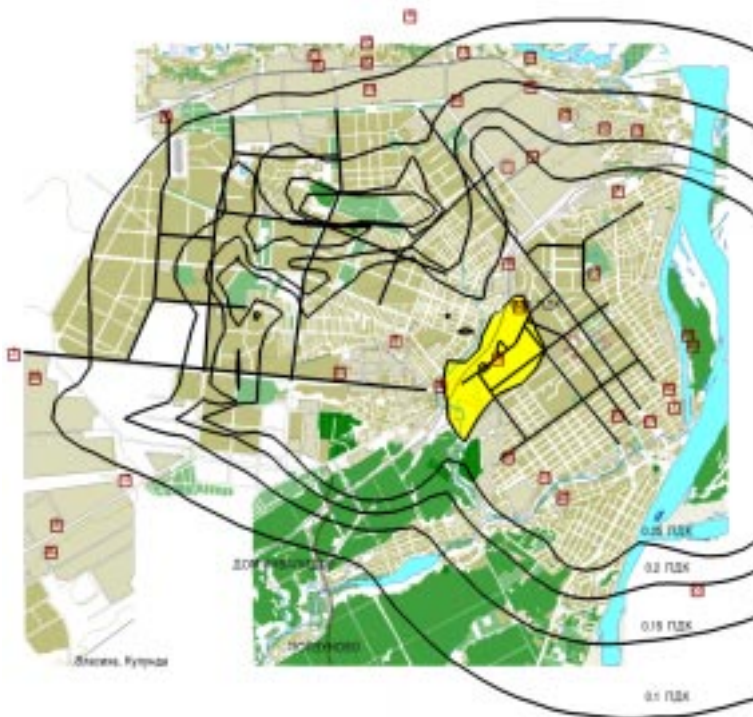
Рисунок 2. Уровень и профиль загрязнения атмосферы г. Барнаула диоксидом азота от выбросов автотранспорта
